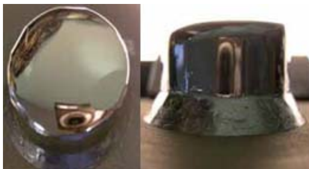
Рисунок 1.7 – Монокристалл-слиток SiC диаметром 75 мм, выращенный по «методу ЛЭТИ» (вид сверху и сбоку)
