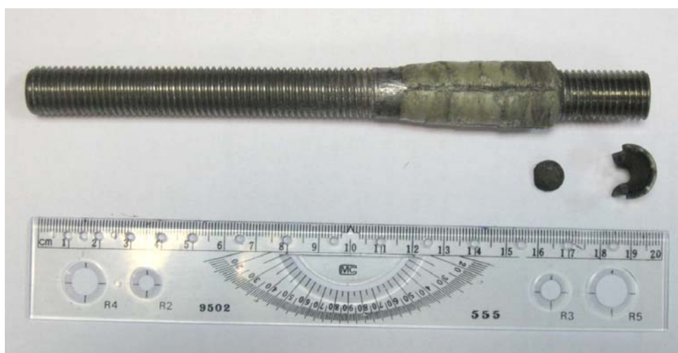
Рисунок 3.5 – Общий вид конструкции узла центрального электрода после его работы и разборки
